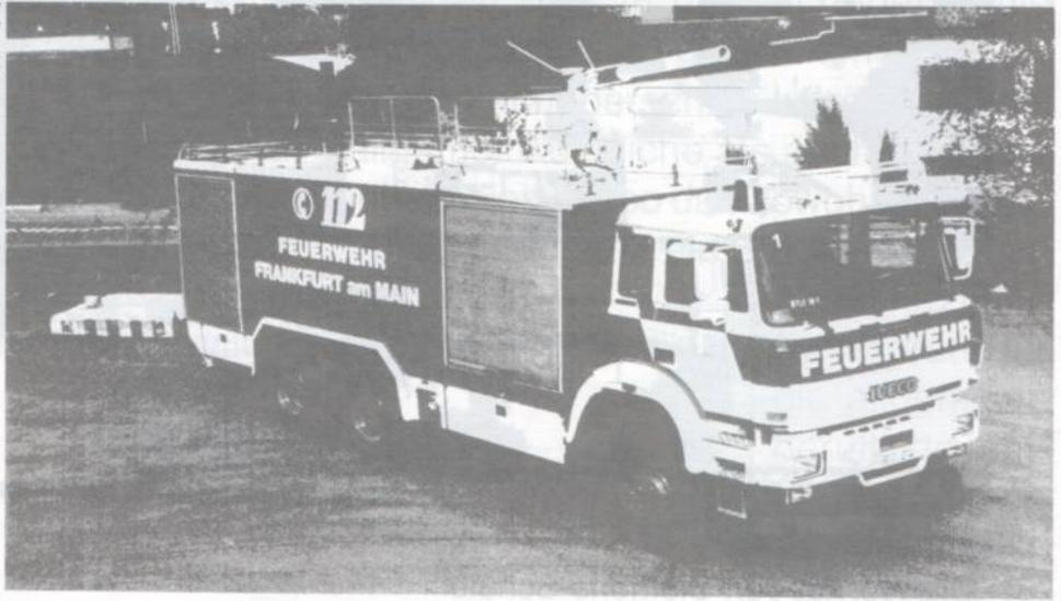
stärkste Fahrzeug der Berufsfeuerwehr ist. Es ist mit einem 8-Gang-Ego-Split-Getriebe ausgerüstet. Das Fahrgestell stammt von Iveco-Magirus. Das 34-Tonnen-Fahrzeug wurde auf der Interschutz in Hannover ausgestellt. Sven Ziegler
